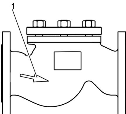
Fig. 2: Flecha que indica el sentido de paso
