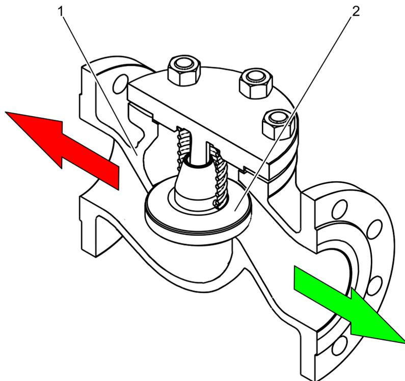
*Fig. 3: Sección de la válvula de retención*
