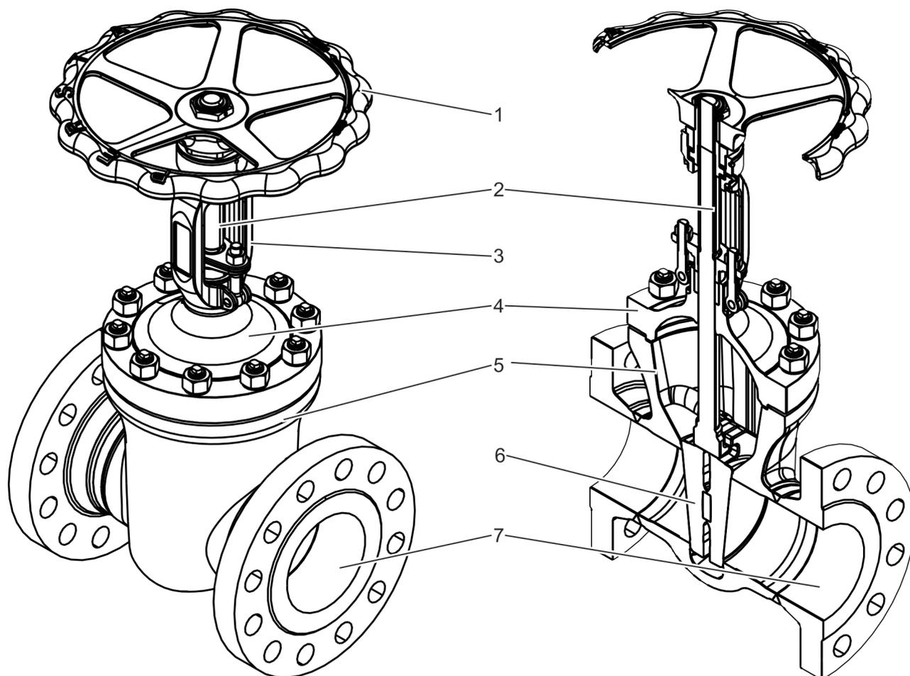
Fig. 1: Válvula de compuerta
