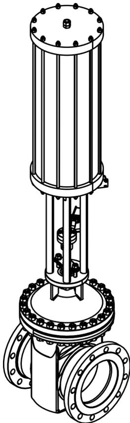
Si la válvula es de accionamiento neumático, el husillo es accionado por un actuador de pistón neumático.
