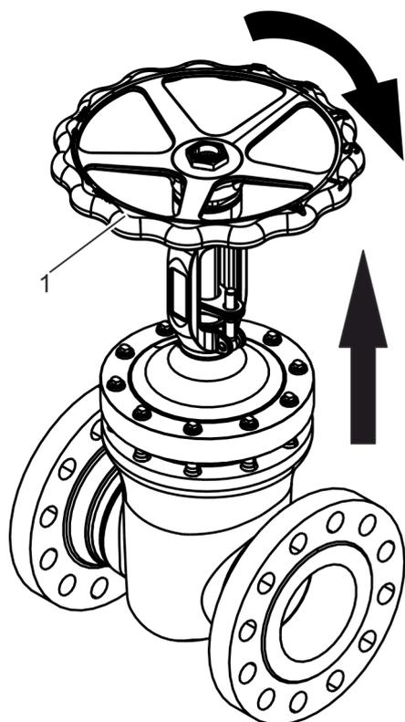
Fig. 22: Accionamiento del volante
