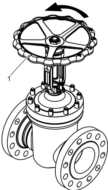
Fig. 27: Accionamiento del volante
