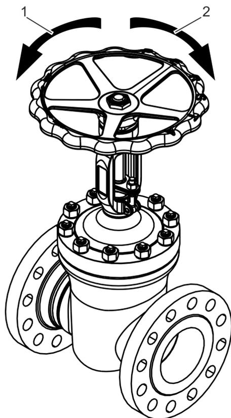
1. ➤ Abra totalmente la válvula girando el volante en sentido anti-horario (Fig. 17/1).
