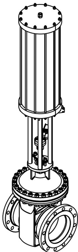
Si la válvula es de accionamiento hidráulico, el husillo es accionado por un actuador de pistón hidráulico.
