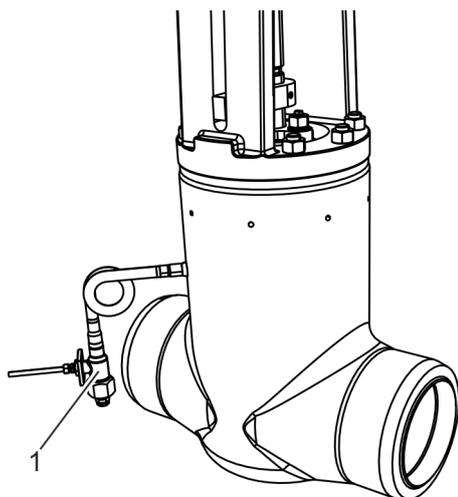
En la boquilla (Fig. 3/2) se instala una válvula de seguridad (Fig. 6/1) que reduce las presiones críticas.
