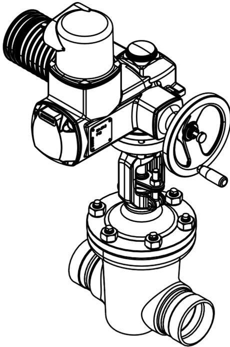
Si la válvula es de accionamiento eléctrico, el husillo es accionado por un motor eléctrico. El motor eléctrico se une a la válvula por la parte superior del bonete.
