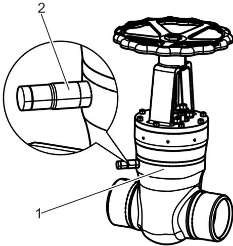
En ciertas aplicaciones, el titular debe equipar la válvula (Fig. 15/1) con un dispositivo exterior de alivio de sobrepresión. Para ello, el fabricante la puede dotar de una boquilla que viene cerrada de fábrica (Fig. 15/2).
