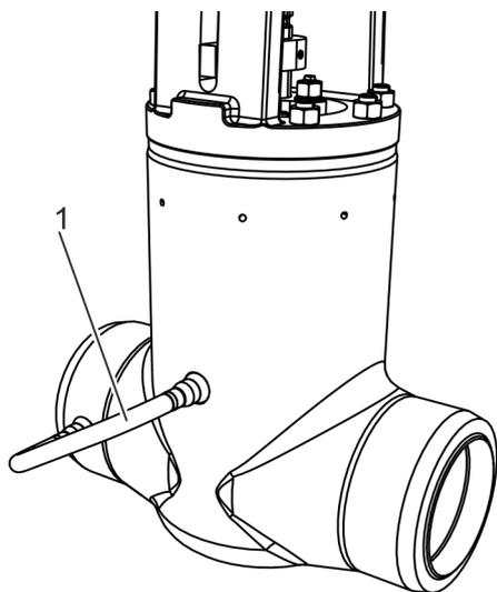
Con la tubería de descarga (Fig. 5/1) se establece una conexión entre la zona 3 (Fig. 2/3) y el lado sometido a presión (Fig. 2/1 (zona 1)) de la válvula.
