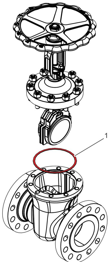
Para evitar que el fluido circulante pueda salir del cuerpo de la válvula, hay montada una junta (Fig. 9/1) entre el cuerpo y la tapa de la válvula. Si se producen fugas, el personal del titular puede cambiar la junta (↪ *Capítulo 8.3.2* »Sustituya la empaquetadura del prensaestopas y la junta de la tapa« en la página 77).
