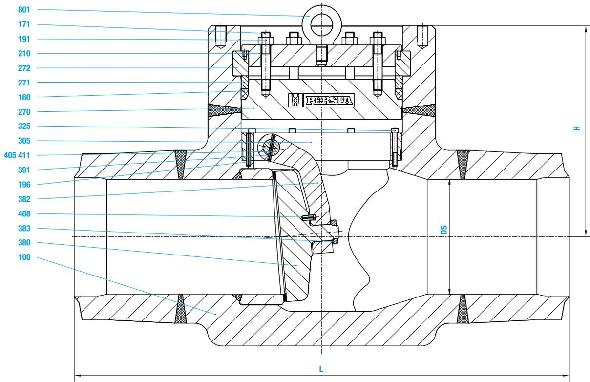
▪ Hochdruck Rückschlagklappen ▪ DRI 16-63 ▪ 640 AB ▪ PD 16-63 ▪ DN 50-600
