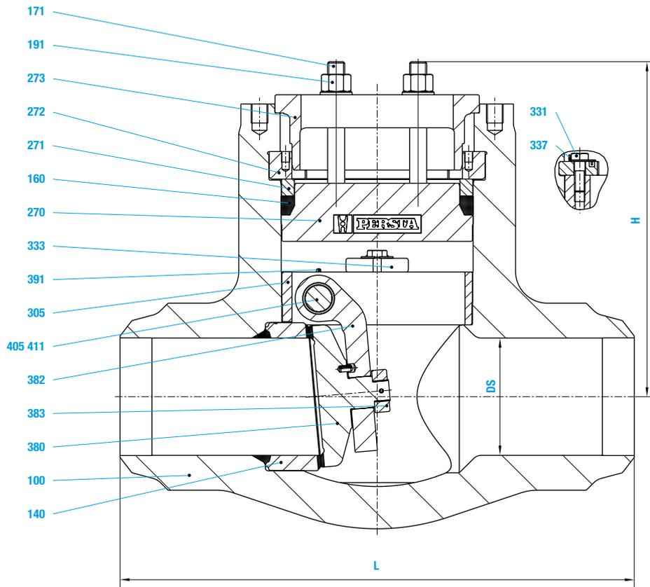
▪ Hochdruck Rückschlagklappen ▪ DRI 26 ▪ 640 AB ▪ PD 25 / PD 40 ▪ DN 65-300
